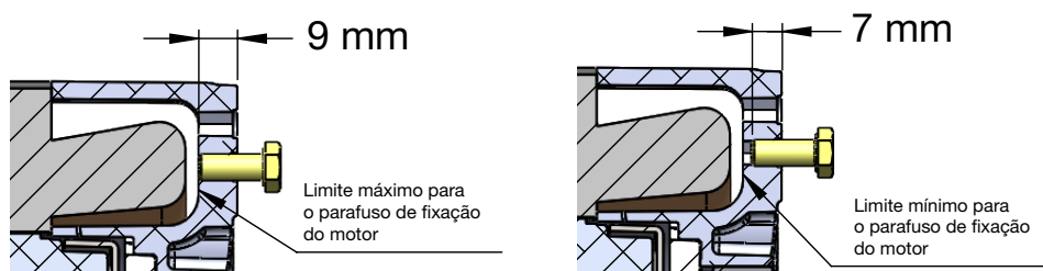
Figura 38 - Limites de profundidade do engaste
