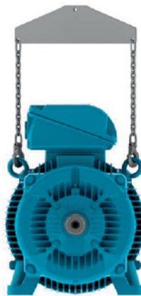
Figura 10 - Uso de barra separadora no içamento
