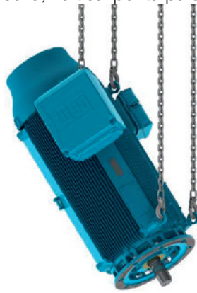
Figura 19 - Colocação dos motores HGF, W50 e W51 HD na vertical
