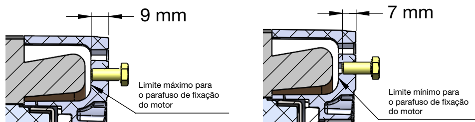
Figura 38 - Límite de profundidad del engaste
