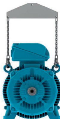
Figura 10 - Uso de barra separadora en la elevación
